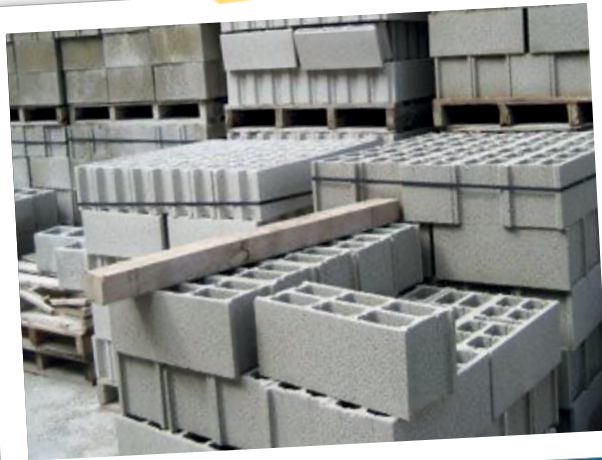
Bloques de mampostería de concreto
